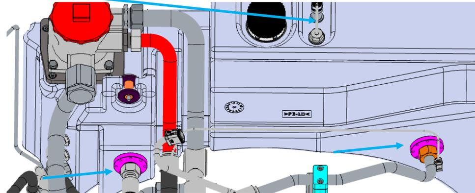
Hydraulikeitungen (9x; s. Pfeile) lösen
